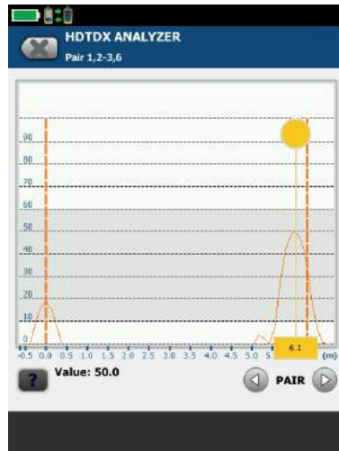
La diafonía de dominio de tiempo de alta definición (High Definition Time Domain Cross talk, HTDTX) muestra que la conexión en el extremo lejano es claramente el problema
