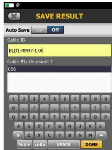
Introduzca rápidamente las identificaciones de cableado con la pantalla táctil capacitiva
